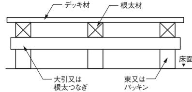
◆設置面に固定ができない場合、大引又は根太つなぎを設置して床面の变形を抑える構造としてください。
