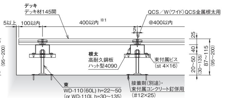
\*受プレート付束(P.38掲載)束WD-110(60L)は、デッキ高さが87~95mm、束W-110Lはデッキ高さが95~175mmの場合は、現場でボルトをカットする必要があります。
