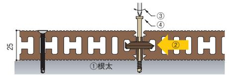
①根太等下地施工 ②デッキ材の溝にQCSを差し込み、次のデッキ材を差し込む
