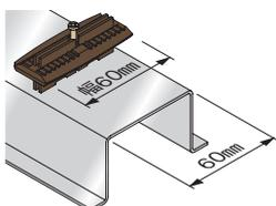
W(ワイド)QCSの幅と同じ60mmの場合、デッキ目地部から根太の金属色が見えにくくなります。
