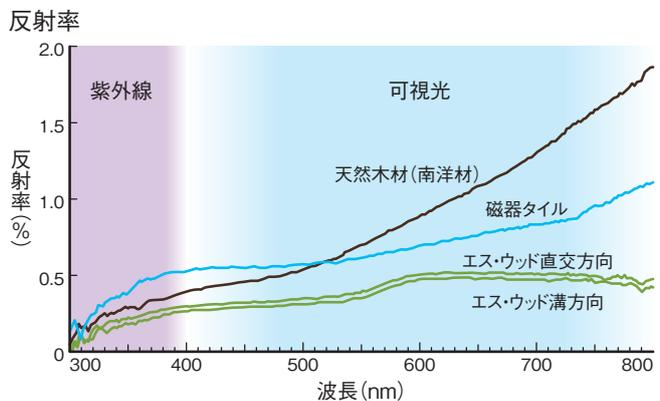
光の反射率(反射量)はエス・ウッドが最も小さい(照り返しが少ない)。有害とされる紫外線(300~400部分)の反射が磁器タイルに比べ約1/2。夏の照り返しによる暑さに対して 暑い ⇔ 涼しい と考えられる。
