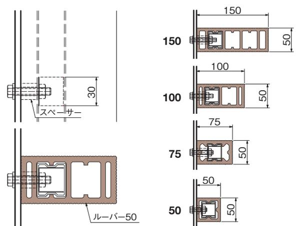
※取付図(B)、L(大)の取付け方をする場合は、ブラケットに穴あけ加工が必要です。
