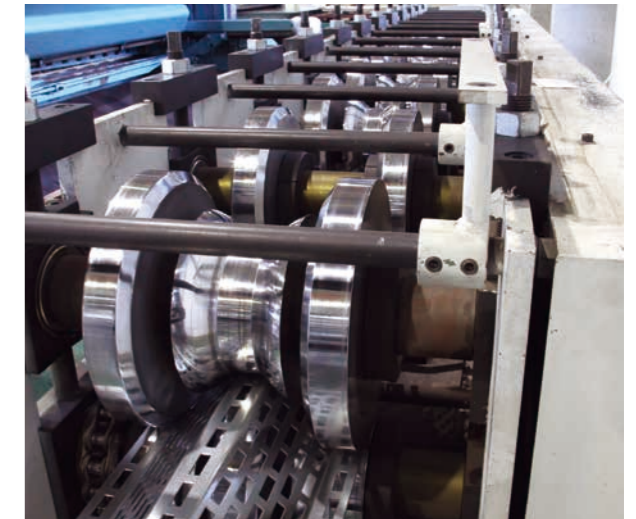
ロールフォーミング成形機による曲げ加工
