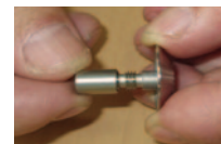
4. 鉾を埋め込み、鉾と床面に隙間がないか、平らに固定されているかを確認する。
