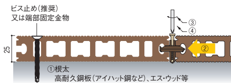
①根太等下地施工 ②デッキ材(145開・95開・220開)の溝にQCSを差し込み、次のデッキ材を差し込む ③QCSを仮固定 ④②、③を繰り返して全体を敷いていき、QCSを本締め ※QCS本体にビス頭がめり込むほど締め過ぎないでください。
