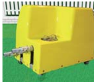
移動式水循環システム (ポンプユニット)
